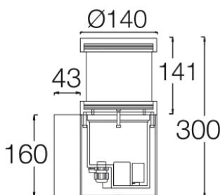
Pre-cableado con 25cm de cable 3x1mm2.
