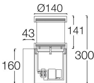
Pre-cableado con 25cm de cable 3x1mm2.
