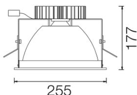
Downlights empotrables de techo con distribución simétrica de la luz para obtener una iluminación de trabajo o general eficaz.
