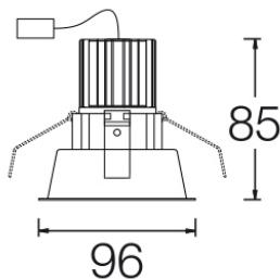
**Luminaire - Puissance connectée:** 5,35 W
