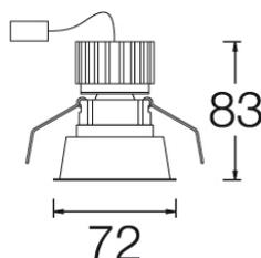
Downlights empotrables al techo con distribución simétrica de la luz para lograr una iluminación de ambiente eficiente.
