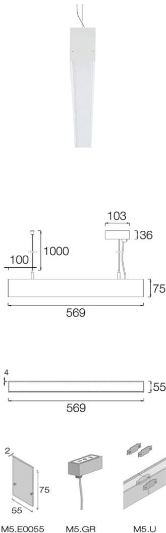
Downlights lineales suspendidos con distribución simétrica de la luz para obtener una iluminación general o de trabajo eficaz.
