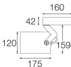
Spots de superficie con distribución simétrica de la luz para obtener una eficaz iluminación de acento, de trabajo o general.
