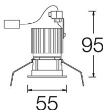
Downlights encastrables al sostre amb distribució simètrica de la llum per obtenir una il·luminació d'ambient eficient.
