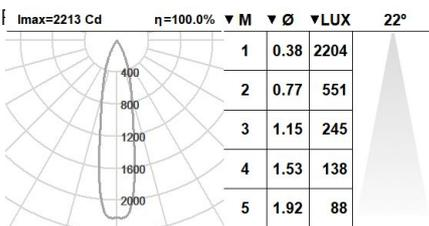
**Luminaire - Puissance connectée:** 4.8 W
